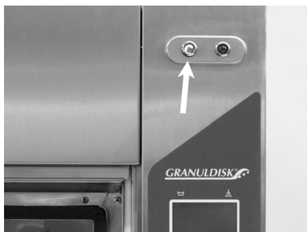
Billede 20: Når programmet er færdigt, tænder den grønne lampe.
