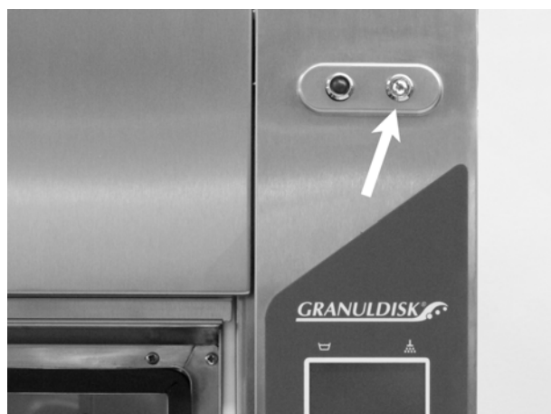
Billede 19: Mens et program kører, lyser den røde lampe.
